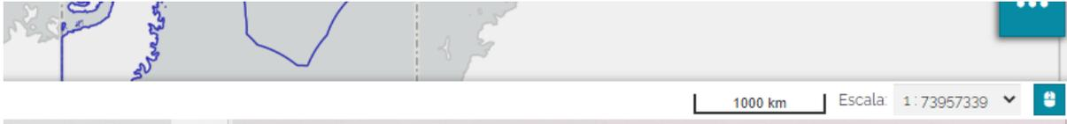
Por defecto, se muestra una barra de escala gráfica y la escala numérica. Y el usuario puede cambiar la barra de escala por el zoom in / out del mapa o seleccionando una escala de mapa del listado predefinido.
